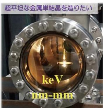
真空と電子衝撃加熱法を用いてクリーンな環境でニッケル球状単結晶を製作し、球面上の一部に平坦面を成長させています。
