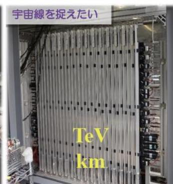
山を貫通する高エネルギー宇宙線を捉え、富士山の内部構造を探っています。研究室で培った技術(粒子線計測と電子回路)を応用。
